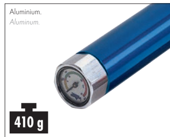
Druckluftkartusche, blau, Aluminium, mit Manometer, 410 g (leer), 450 g (befüllt), 430 mm lang. Compressed air cylinder, blue, aluminum with manometer, 0.9 lbs (empty), 0.99 lbs (full), 16.9 inch long. Best.-Nr.: 013358
