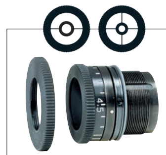
Super-Irisringkorn 9740 Ø 2,8 - 4,8 mm, verstellbar. Das Durchsichtsbild kann mit einem mitgelieferten Werkzeug von Fadenkreuz auf Querbalken verstellbar und somit den Wünschen des Schützen individuell angepasst werden. Dieses Ringkorn wird zusätzlich mit einem größeren Rändelring geliefert, um das Zielbild besser abdecken zu können. Das ANSCHÜTZ Super-Iris-Ringkorn wird mit Einschraubgewinde M18 x 0,5 mm geliefert.
